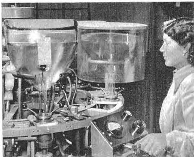
**Metallisieren des Leuchtschirms.** Lorenz-Bildröhren erhalten zusätzlich noch eine Metallhinterlegung des Leuchtschirms, die Lichtausbeute und Bildkontrast annähernd verdoppelt. Damit das Metall sich als hauchdünne, spiegelnde Folie glatt über die Leuchtstoffkristalle spannt, muß der Leuchtschirm zunächst mit einer Haut aus organischen Stoffen überzogen werden. Auf diese kann dann im Vakuum Aluminium in etwa  $1,5 \cdot 10^{-1}$  mm Stärke aufgedampft werden
