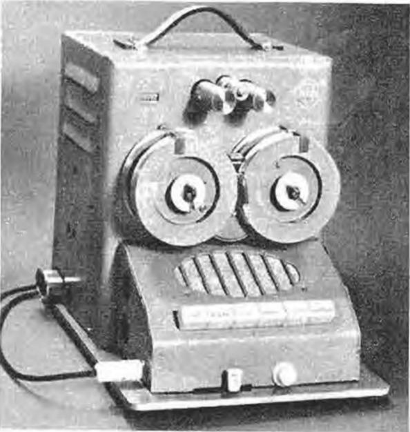
Magnetton-Diktiergerät „D 5“ mit Fernschaltgerät
