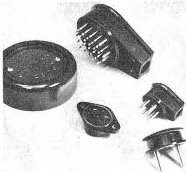
Oben: Steckverbindung „Mes/Med 360“; rechts: 6polige Steckverbindung „Mes/Meb 60“; unten Mitte: Einbaubuchse für „Mes/Meb 60“; rechts unten: Netzstecker mit seitlicher Kabelabführung
