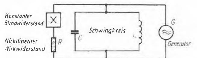
Abb. 5. Schwingkreis mit innerer Frequenzrückkopplung durch einen RX-Modulator
