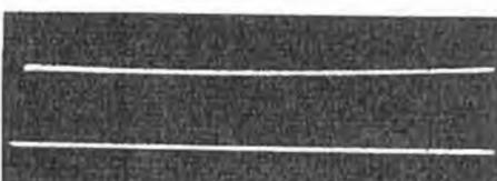
Anode-Hexode ( $S_1$  geschlossen).  $U_{g_{21}} > U_{g_{211}}$ , nicht synchronisiert
