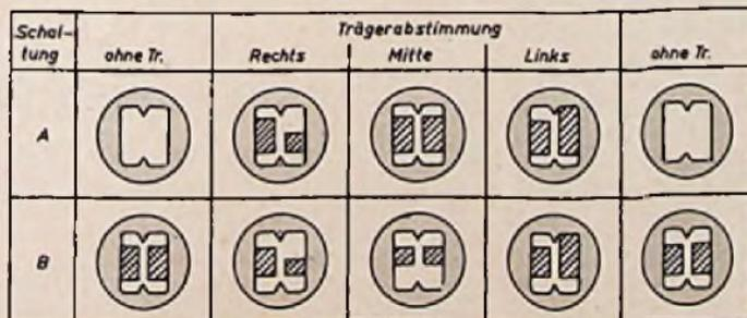
Schirmbilder der Anzeige bei Verwendung der Schaltungen nach Abb. 21 A und 21 B
