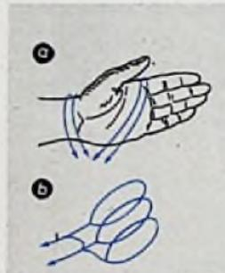
Abb. 1. Die beiden Elektroden bestehen aus je einer Drahtschleife, die um die Hand oder das Handgelenk gelegt werden (a); zur Erhöhung der Empfindlichkeit kann die eine Elektrode aus zwei parallelgeschalteten Schleifen gebildet sein, zwischen denen die andere Elektrode liegt (b)
