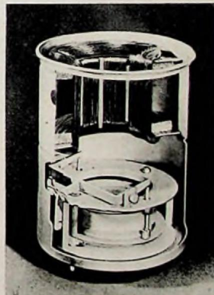
Abb. 84. Schnitt durch die Ablenk- und Fokussiereinheit „AT 1000/01“
