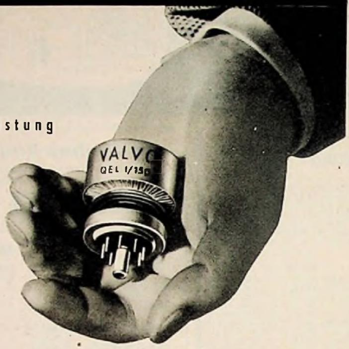
Die hervorragende mechanische Stabilität der QEL 1/150, ihre hohe Leistungsverstärkung und ihr günstiges S/C-Verhältnis geben die idealen Voraussetzungen für den Einsatz der neuen Röhre in Fernseh- und FM-Rundfunk-Verstärkern, in kommerziellen UKW- und Dezimeter-Verbindungen sowie in industriellen Anlagen wie z. B. in HF-Generatoren für kapazitive Erwärmung. Dabei eignet sich die Röhre wegen ihrer kleinen Abmessungen und wegen ihrer mechanischen Festigkeit ganz besonders für fahrbare Geräte.
