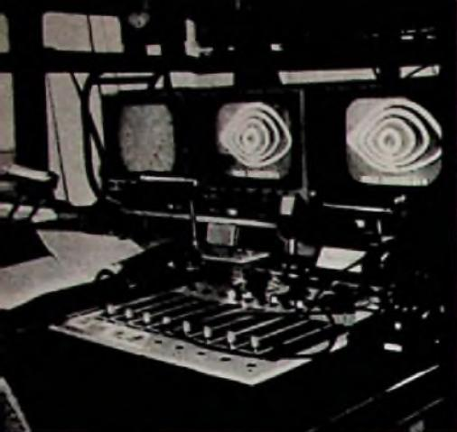
Mischpult- und Kontrollempfänger im NWDR-Fernseh-Übertragungswagen. Auf den beiden Kontrollempfängern rechts unten ist das mit dem ersten Preis ausgezeichnete Pausenzeichenbild erkennbar
