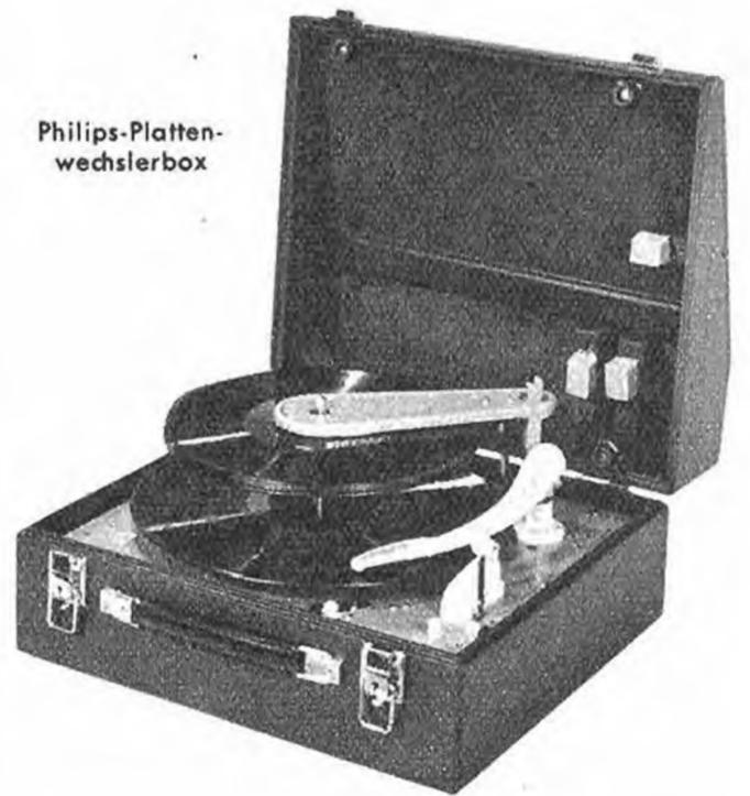
wechseln. Die neue Spezial-Abwurfvorrichtung nimmt bis zu 12 dieser Platten auf und bietet den Vorteil, daß sich lediglich der untere Teil mit dem Plattenteller dreht, während der obere feststeht und eine Reibung der Platten untereinander während des Abspielens verhindert. Plattenspieler „275“ und Plattenwechsler verwenden ein dreistufiges Geräuschfilter. Der Quecksilberschalter gestattet eine rückstoßfreie Ausschaltung.
