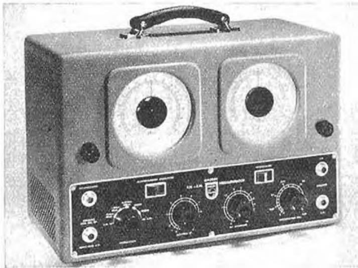
Abb. 10. AM/FM-Meßgenerator „GM 2889“ (Philips)
