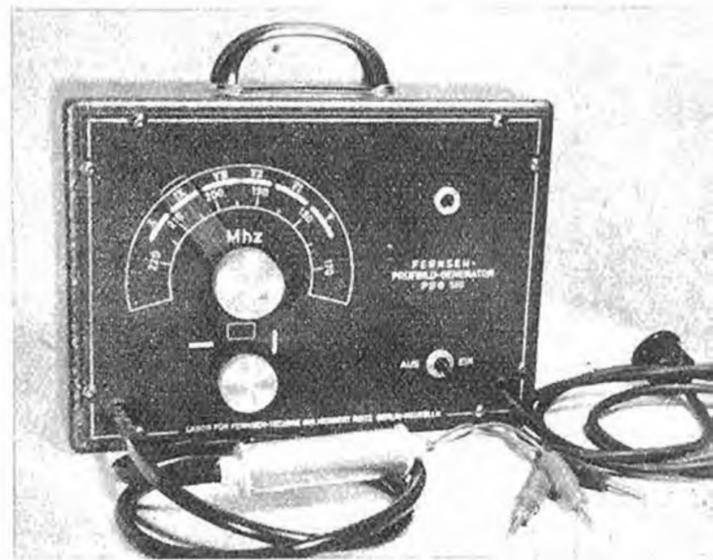
Abb. 11. Fernseh-Prüfbildgenerator von H. Reitz
