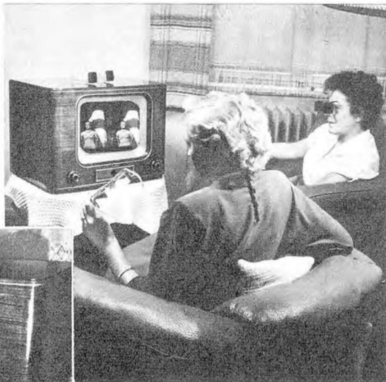
Dieses plastische Fernsehen arbeitet nach dem Stereoverfahren mit zwei getrennten Teilbildern. Die Betrachtung muß mit einer besonderen Prismenbrille oder, wenn vor dem Fernseh-Schirmbild Polarisationsfolien vorgesetzt werden (s. linkes Foto), mit einer einfachen Polarisationsbrille erfolgen. Die Herstellung entsprechender Betrachtungsgeräte wird von der Fa. Roka aufgenommen
