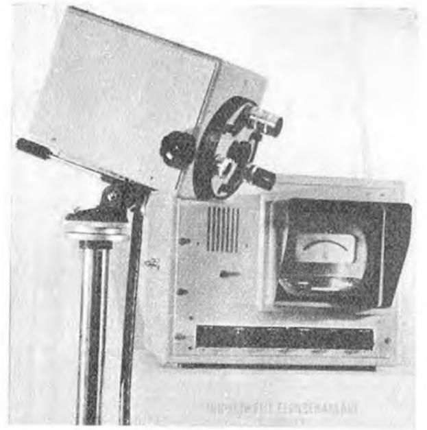
Kamera und Sichtgerät der Philips-Anlage
