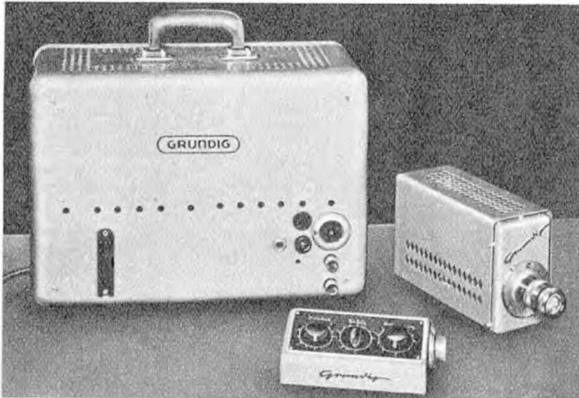
Die unter der Bezeichnung „Grundig-Fernaube“ herausgebrachte Fernseh-Aufnahmeapparatur verwendet als Aufnahmekamera ein Vidikon und zeichnet sich durch geringe Abmessungen und kleinen Preis aus. Als Bildwiedergabegerät eignet sich jeder normale Fernsehempfänger. Zur Anlage gehören die Aufnahmekamera, das Steuergerät und das Bedienungskästchen.
