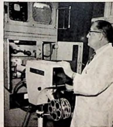
um seine Achse um  $180^\circ$  drehbar oberhalb des Gehäusebodens angeordnet. Diese Verstellmöglichkeit gestattet, gewisse Bildfehler (z. B. Flimmern) durch Angleichen der Phase der Film- und Prismenbewegung an die Phase des geschriebenen Rasters zu beseitigen. Für die Güte der Abtastung des Filmbildes spielen auch die Größe des Prismas und die Genauigkeit seines Schliffs eine wesentliche Rolle. Für Vor- und Rücklauf ist ein Umschalter mit Haltestellung vorgesehen.
