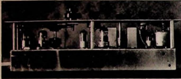
Abb. 4. Empfängereinschub. Der Aufbau gleicht dem des Klein- und Senders Tx 2/002. Das Chassis hat die Abmessungen: Länge 39 cm, Breite 7,5 cm, Höhe 5 cm, Gesamthöhe 12 cm
