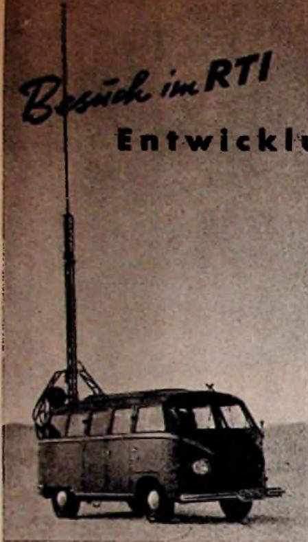
Feldstärke-Meßwagen des RTI mit Antennenmast
