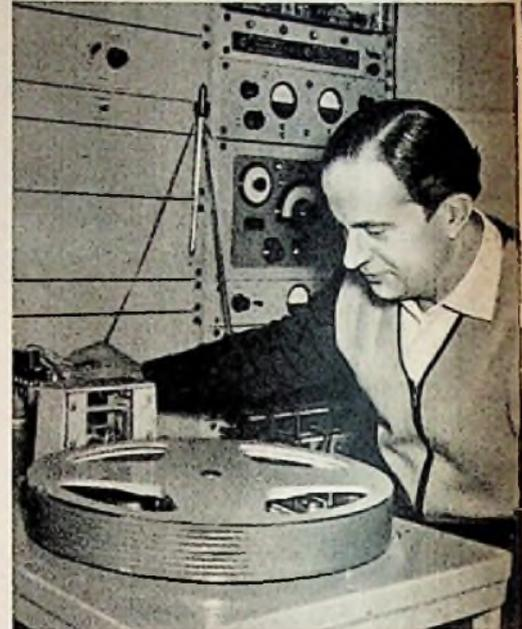
Pausenzeichengerät des RTI. Das Magnettonband ist spiralförmig auf einen Zylinder aufgewickelt. Der Hörkopf gleitet in einem fahrluhartigen Schlitzen während der Umdrehungen des Tellers mit dem Magnettonband auf und ab (Aufn. dpa)
