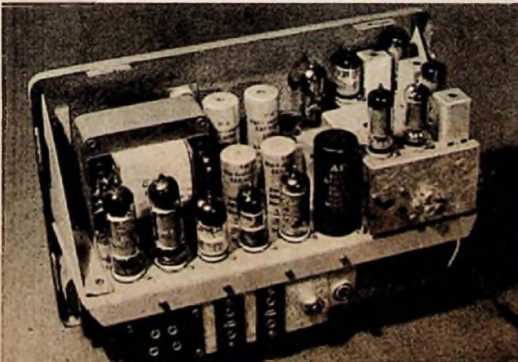
Chassisansicht des „Diwefon 15“ mit rechts eingesetztem UKW-Teil. Rechts: Chassisansicht des UKW-Teils
