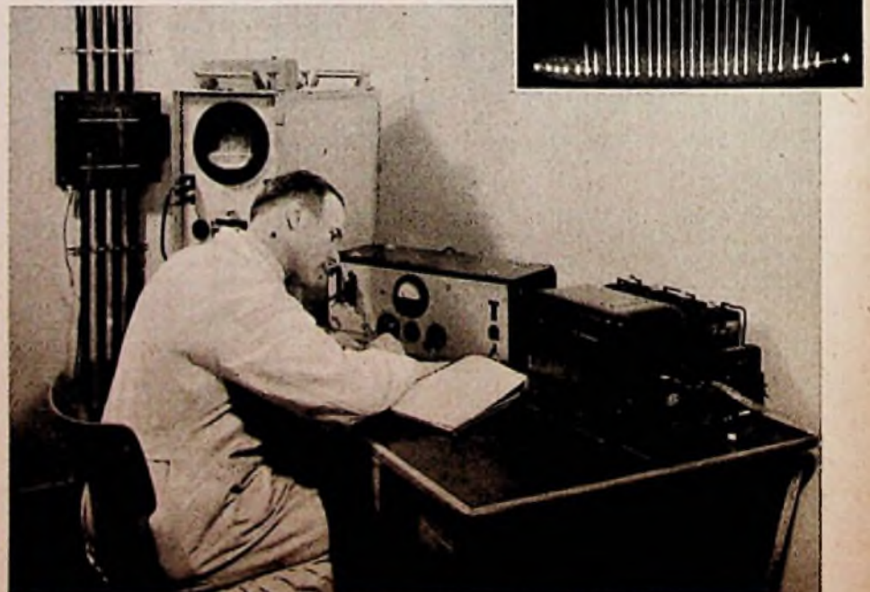
Ablesung der Meßinstrumente im Nebenraum. Links = Siemens-Spektrometer, Mitte = DIN-Lautstärkemesser, rechts = Lochstreifensender, rechts oben = Spektrogramm zur Frequenzanalyse der Geräusche (Bildschirmaufnahme)
