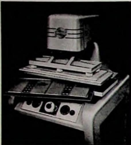
Die Körting-Motorschweißpresse „MF 400“ dient in Verbindung mit dem Körting-2-kW-HF-Generator „Fixus G 2000 S“ zur Verarbeitung von Kunststoffen zu Gebrauchsgegenständen verschiedenster Art. Das Foto zeigt die Verwendung der Presse für die Herstellung von Bucheinbänden
