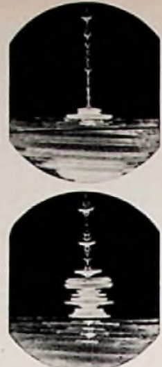
Außen- und Innenansicht des Anzeigegegeräts der „Fischlupe“. Rechts: zwei typische Schirmbilder; die seitlichen starken Auslenkungen weisen auf Fischschwärme in der an einer Skala ablesbaren Tiefe hin. Das obere Bild zeigt z. B. noch deutlich größere Fischschwärme dicht über dem Grund
