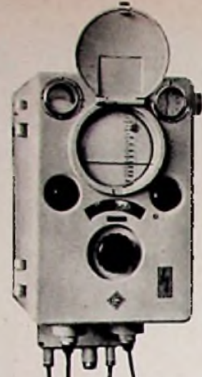
Außen- und Innenansicht des Anzeigegegeräts der „Fischlupe“. Rechts: zwei typische Schirmbilder; die seitlichen starken Auslenkungen weisen auf Fischschwärme in der an einer Skala ablesbaren Tiefe hin. Das obere Bild zeigt z. B. noch deutlich größere Fischschwärme dicht über dem Grund
