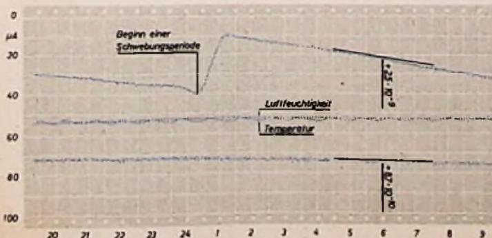
Abb. 2. Registrierung des Quarzkellerklimas, Vergleich des Reservequarzes und der Normalfrequenz der Zentralkontrolle mit der Betriebsnormalfrequenz
