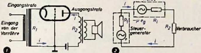
Abb. 1. Grundschaltung der als Gitterbasis-Verstärker geschalteten Endstufe
