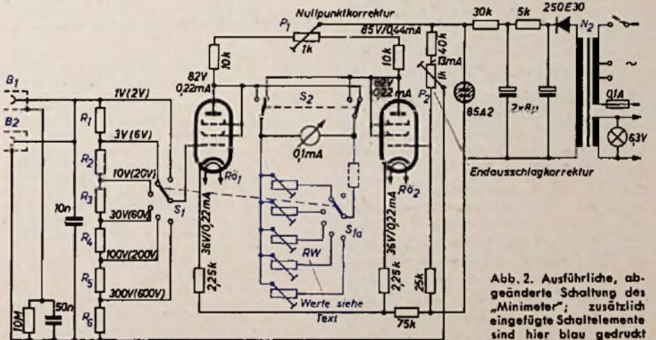
Abb. 2. Ausführliche, abgeänderte Schaltung des „Minimeter“; zusätzlich eingefügte Schaltelemente sind hier blau gedruckt
