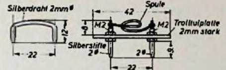
Abb. 4. Maße des „Kurzschluß“-Bügels (Steckspule des Bereichs III); rechts: Maße der Steckerplatte aus Trolitul für die Spulen der Bereiche I und II
