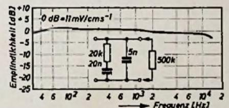
Frequenzkurve des dynamischen TA-Systems „Ortoton“ (Elac) mit Abschluß durch Entzerrerschaltung nach einem Anpassungsübertrager Type „Gl 3462 B“
