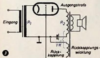
Abb. 2. Die außerordentlich einfache Ersatzschaltung der Gitterbasisschaltung
