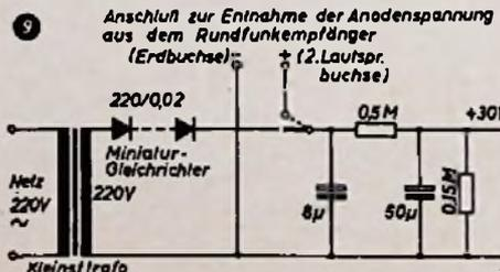
Abb. 9. Kleinst-Anodenspannungsteil
