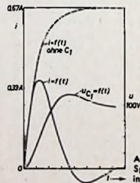
Abb. 4. Verlauf von Spannung und Strom in der Ersatzschaltung
