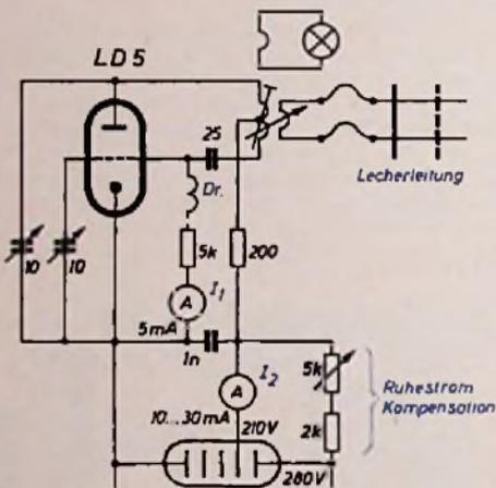
Abb. 10. Schaltung der Eichrichtung, bestehend aus einstufigem Hilfssender mit angekoppeltem Lechermeßsystem zum Messen der Wellenlänge
