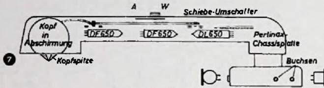
Abb. 7. Beispiel für einen Verstärker-Einbau in den Tonarm
