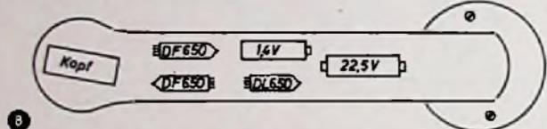
Abb. 8. Unterbringung von Verstärker und Miniatur-Batterien in einem älteren, größeren Tonarm
