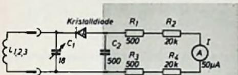
Abb. 1. Schaltung des Absorptionsfrequenzmessers
