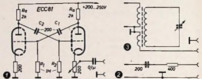
der Katode des einen Systems ausgekoppelt. Diese Schaltung hat den Vorteil, daß die Ausgangsamplitude tatsächlich bis auf Null geregelt werden kann und eine niederohmige Anpassung gewährleistet ist. Die universelle Verwendbarkeit des Gerätes sei an einigen Beispielen gezeigt.
