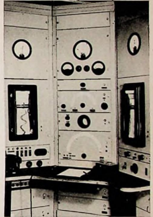
Abb. 3. Mittelwellenfrequenzmeßplatz mit Doppelrückmischsuper und Hilfsoszillator. Mit Schreibern werden Gleichwellenschwebungen registriert
