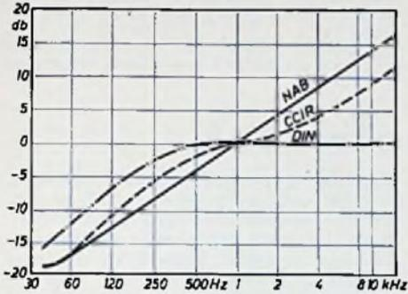
Schneidkurven-Entzerrung des Verstärkers „V 83“ für eine frequenzunabhängige Ausgangsspannung
