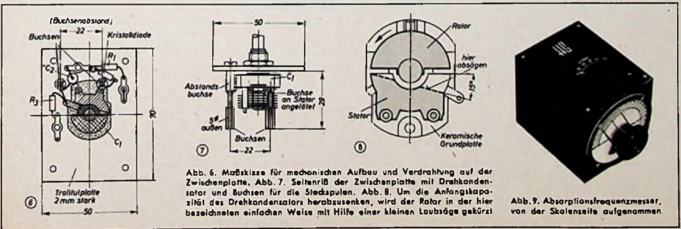
Abb. 6. Maßskizze für mechanischen Aufbau und Verdrahtung auf der Zwischenplatte. Abb. 7. Seitenriß der Zwischenplatte mit Drahkondensator und Buchsen für die Steckspulen. Abb. 8. Um die Anfangskapazität des Drahkondensators herabzusetzen, wird der Rotor in der hier bezeichneten einfachen Weise mit Hilfe einer kleinen Laubsäge gekürzt
