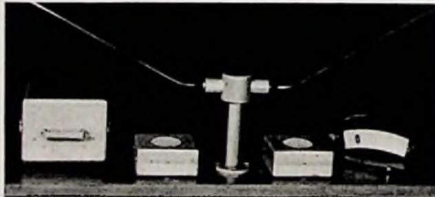
Abb. 1. UKW-Rangierfunkanlage: Empfänger, Lautsprecher, Antenne u. Sender
