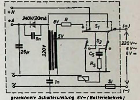
gezeichnete Schalterstellung 6V = (Batteriebetrieb)
