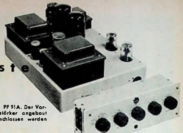
Der Hauptverstärker PF 91 mit Vorverstärker PF 91A. Der Vorverstärker kann direkt an den Hauptverstärker angebaut oder über ein Kabel mittels Stecker angeschlossen werden
