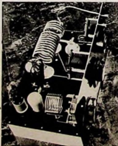
Die typische Brettschaltung (links) der meistens selbsterregten Amateursender früherer Jahre. Später (oben) ging man schon oft auf die Chassisbauweise über, wie dieser zweistufige quartzgesteuerte Sender etwa aus dem Jahre 1934 zeigt. Welch enorm schnelle Entwicklung auch die Amateurtechnik durchgemacht hat, läßt sich an dem rechten Foto erkennen, das einen Dezimeter-Superhet für 2400 MHz von HB 9 BW zeigt
