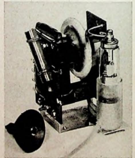
Abb. 20. Zeilentransformator von Tonfunk mit der leicht auswechselbaren Hochspannungsröhre EY 86
