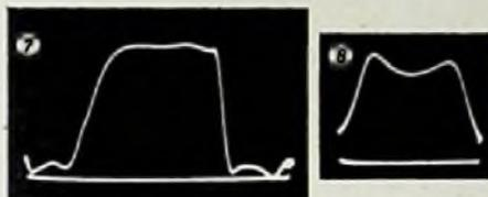
Abb. 7. Durchlaßkurve des Kanalwählers in den Loewe Opta-Fernsehempfängern. Abb. 8. ZF-Kurve der Loewe Opta-Fernsehempfänger
