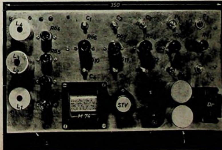
Eisenkern vorgenommen. In einem ähnlichen „halben“ ZF-Einheitsabschirmbecher ist auch L4 am hinteren Teil des Chassis untergebracht. Hier sind zwei Kreuzwickel von ehemaligen Oszillatorabstimmspulen für den Mittelwellenbereich, ebenfalls hintereinandergeschaltet, auf einem gleichen Trolitulrohr mit Lötösenflansch aufgeklebt.
