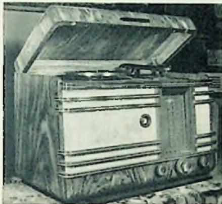
Zwei Beispiele aus der Empfängerproduktion der UdSSR: Phonosuper „Minsk R 7“, ein 7-Röhren-Super, und der Fernsehempfänger „Avantgard“
