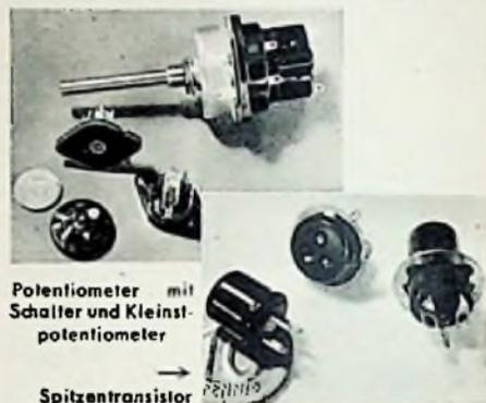
Potentiometer mit Schalter und Kleinstpotentiometer
