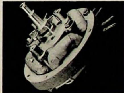
Laufwerkmotor (Elektrogerätebau Leisnig)
