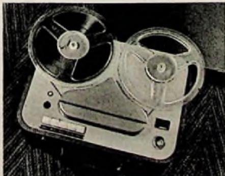
Als Koffer und auch als Chassis sah man an verschiedenen Ständen das neue mit 5 Drucktasten versehene Gerät „5401/19“ von N. Flohr, Oberlungwitz (3 Köpfe; 19,05 cm/s; 50...12000 Hz mit CH-Band; schneller Vor- und Rücklauf; Wiedergabeentzerrer; Aussteuerungsanzeige; 2X EF 12 k, EF 14, 6 X 5, EM 11).
