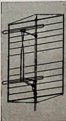
„Reflecta 2“, eine neue Reflektorwand-Antenne
