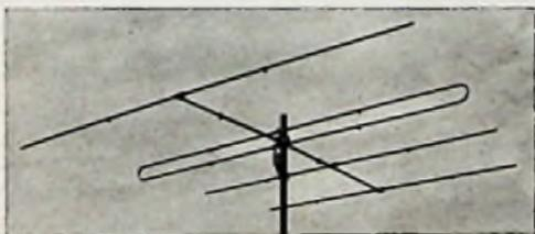
„Varia 1“, eine Einebenen-Antenne für hohe Ansprüche. Links daneben: „Recta-R“, ein verkürzter Dipol mit Kanal-Anpaßschleife
