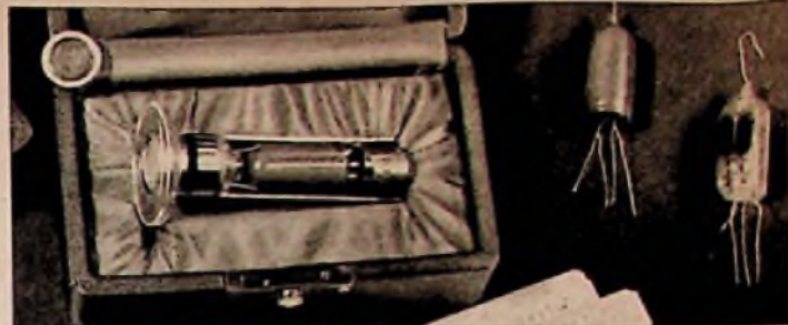
Links: Tonsirene für Mikrofonmessungen (G. Neumann). Oben: Kondensator-Kleinmikrofon „M 59“ mit Spezialröhre MSC 2 (A. Hiller KG.)
