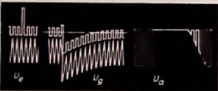
Abb. 2. Einfluß von Störimpulsen auf das Amplitudensieb eines Fernsehempfängers
