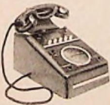
Abb. 9. Rangierfunksprechstelle für die Besprechung ortsfester Sende-Empfangs-Geräte
