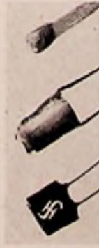
Abb. 1. Zwei Germanium-Fotodioden deutscher Hersteller im Größenvergleich mit einem Zündholz
