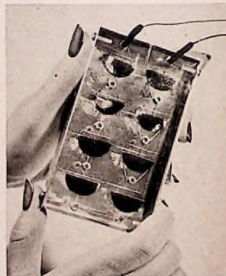
Die aus vielen Einzelzellen bestehende Sonnenbatterie für die Speisung des kleinen tragbaren Transistorsenders. Das Grundelement der Sonnenbatterie besteht aus einem besonders präparierten Plättchen aus Silizium in der Größe von etwa einer Rasierklinge (s. linkes Foto). Mehrere solcher Einzelelemente können in Serie zu einer leistungsfähigen Batterie zusammengeschaltet werden. Die Sonnenbatterie vermag Sonnenenergie direkt und mit gutem Wirkungsgrad in verwertbare elektrische Energie umzuwandeln
