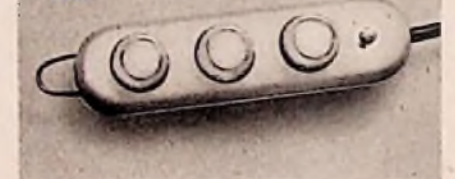
Abb. 9. Schaltung und Ansicht der Graetz-Fernbedienung für Helligkeit, Kontrast und Lautstärke sowie eine zusätzliche Ton-Aus-Taste
