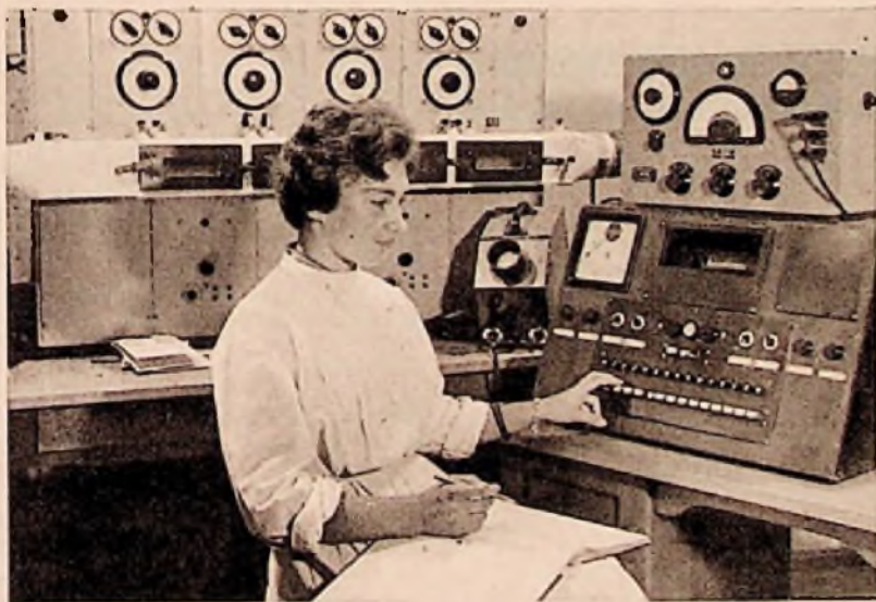
Messung des Temperaturkoeffizienten von keramischen Kondensatoren. Rechtes Foto: Temperatur-Meßschrank für einstellbare Temperaturschleifen im Bereich von etwa -65^{\circ}\text{C} ... +80^{\circ}\text{C}
