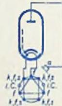
Abb. 3. Sockelschaltung der EY 86 und DY 86
