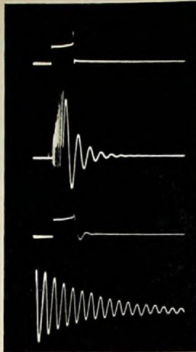
Abb. 12. Spannung an einem Unterbrecherkontakt beim Abschalten einer induktiven Last von einer Gleichspannungsquelle; a) offener Kontakt, b) Kontakt mit  $C$  ( $6800 \text{ pF}$ ) überbrückt, c) Kontakt mit  $CR$  ( $6800 \text{ pF} + 27 \text{ k}\Omega$ ) überbrückt, d) 500-Hz-Zeitmarke
