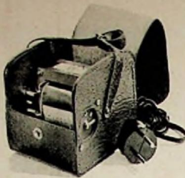
Abb. 2. Der Trenntransformator kann in einer eleganten Fototasche untergebracht werden. Der Netzspannungswähler ist mit Zelluloid abzudecken
