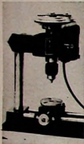
Aufbau als Tischbohrmaschine (Grundausstattung)
