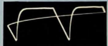
Abb. 9. Getriggerte Kippspannung mit schwacher Zeitdehnung
