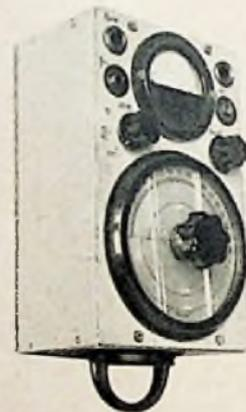
Abb. 3. Ansicht des Tastfrequenzmessers
