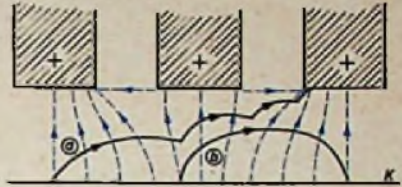
Abb. 15. Bahn zweier Elektronen in einem oszillierenden Magnetron; a) Bahn eines Energie liefernden Elektrons, b) Bahn eines Energie aus dem HF-Feld absorbierenden Elektrons
