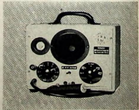
Vielspur-Magnetbandanlage für die gleichzeitige Aufnahme von bis zu 14 Gesprächen auf einem Tonband. Dieses Gerät von W. Assmann wird vornehmlich in Flugsicherungsdiensten verwendet
