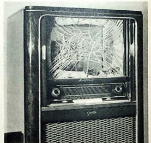
Bei Bildröhrenimplosionen besteht für den Betrachter keine Gefahr, denn die 6 mm starke Sicherheitsglas-Schutzscheibe schützt sicher vor allen Splintern, wie Versuchsreihen von Graetz bewiesen haben (Luxus-Fernseh-Rundfunkkombination „Kurfürst“ nach einem Implosionsversuch)
