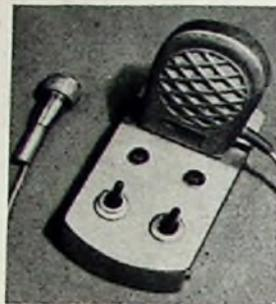
Ansicht des Peiker-Mikrofons „PM 23“ mit Fernbedienungssockel und Verdrahtung unterhalb der Montageplatte des kleinen Fernbedienungssockels
