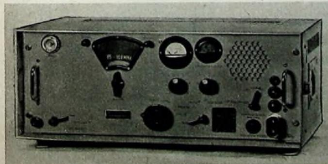
VHF-Überwachungsempfänger „ESM 300“ für den Frequenzbereich 85...300 MHz (Rohde & Schwarz)
