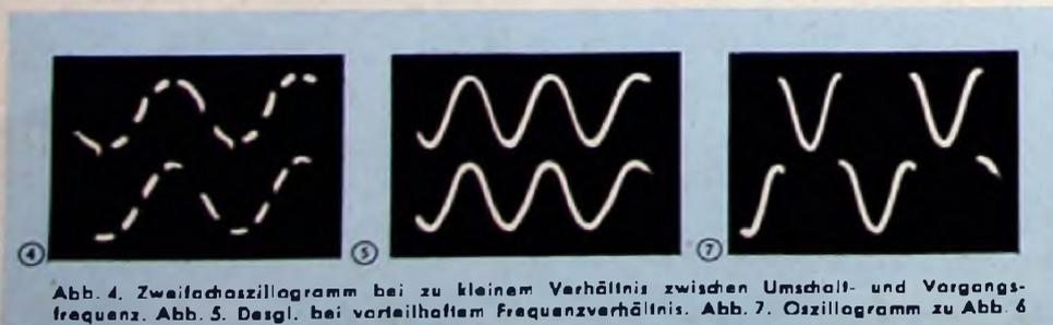
Abb. 4. Zweifachoszillogramm bei zu kleinem Verhältnis zwischen Umschalt- und Vorgangsfrequenz. Abb. 5. Desgl. bei vorteilhaftem Frequenzverhältnis. Abb. 7. Oszillogramm zu Abb. 6
