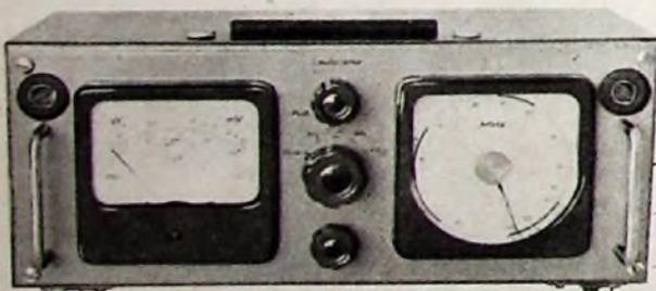
Abb. 1 Ansicht des UKW-Spannungsmessers (A. Klemt, Olching bei München)
