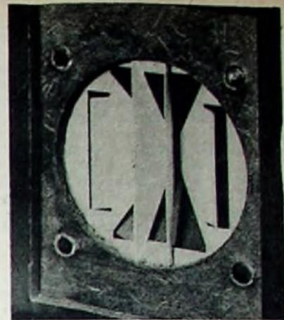
Durch Schallverteiler konnte die Abstrahlung der Lautsprecher verschiedenlich verbessert werden. Das Foto zeigt den Schallverteiler für die dynamischen 3 D-Seitenstrahler bei dem neuen „Super High Fidelity Raumklangsystem“ von Blaupunkt.
