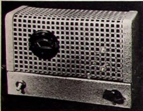
Abb. 1. Der Standardsender ist in einem form-schönen Gehäuse untergebracht, das die empfindlichen Einzelteile bei Schlag und Stoß schützt und eine gute Wärmeabstrahlung gewährleistet.
