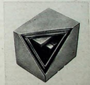
Abb. 4. Schnitt durch eine Doppelabschirmung
