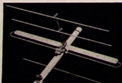
Abb. 2. Fernseh-Kanalantenne mit angepaßten Blechen für genaue Anpassung an den Wellenwiderstand der angeschlossenen Leitung
