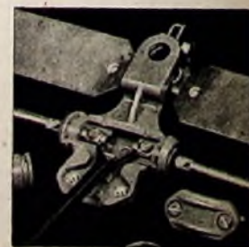
Abb. 2. Fernseh-Kanalantenne mit angepaßten Blechen für genaue Anpassung an den Wellenwiderstand der angeschlossenen Leitung
