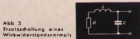
Abb. 3. Ersatzschaltung eines Wirkwiderstandsnormalen
