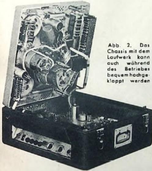
Abb. 2. Das Chassis mit dem Laufwerk kann auch während des Betriebes bequem hochgeklappt werden
