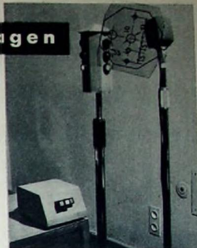
Leuchtsäule mit Bedienungsgerät und Mikrofon
