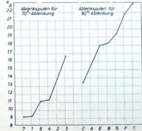
Abb. 3. Gütezahlen  $K_R$  von Ablenkeinheiten, bezogen auf  $U_a = 14 \text{ kV}$ ; Vertikal-Ablenkung
