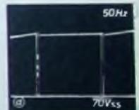
Am oberen Abnahmepunkt der Spannung für den Phasendiskriminator (vor dem 1-nF-Kondensator)
