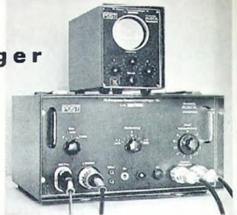
Abb. 3. Ansicht des FS-Frequenz-Panoramaempfängers; oben Sichtteil, darunter Empfangsteil
