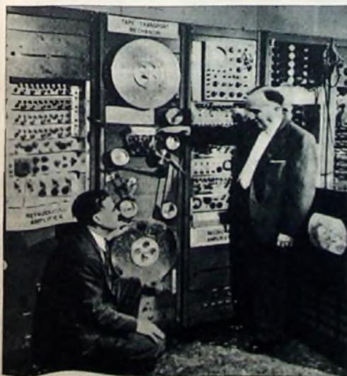
Abb. 3. Versuchsanlage der RCA für direkte Aufzeichnung mit 9 m/s Bandgeschwindigkeit
