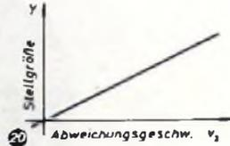
Abb. 20. Kennlinie des D-Anteils
