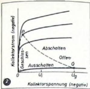
Abb. 2. Kollektorkennlinien des Transistors und Weg des Arbeitspunktes während einer ganzen Periode
