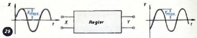
Abb. 29. Prinzip zur Aufnahme des Frequenzganges
