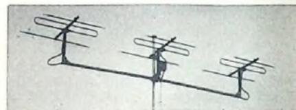
doch mit Hilfe der Blögeenden auf je einen von drei Kanälen abgestimmt werden. Trotz der unvermeidlichen Größe wird auch die „Troika“ vormontiert geliefert. Der rund 2 m lange Querträger mit Rechteckprofil ist sehr stabil, so daß schädliche Schwankungen auch bei starkem Wind nicht zu befürchten sind.
