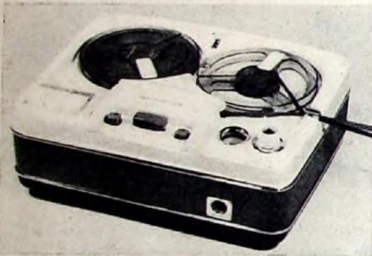
Das Magnetophon „KL 65“ (Telefunken) ist auch mit Vorrichtung zum Anschluß an Schmalfilmvorführgeräte lieferbar
