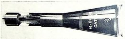
Kathodenstrahlröhre DG 10-74 mit Planschirm (Valvol)
