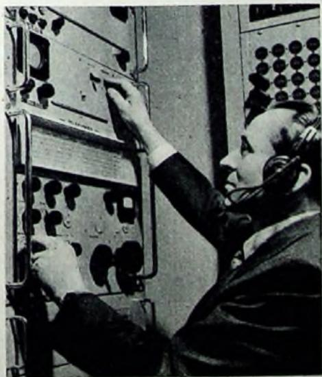
Beim Arbeiten mit dem Einseitenband-Zusatzgerät. Die praktische Kopfhörer-Mikrofon-Garnitur erleichtert die Verständigung
