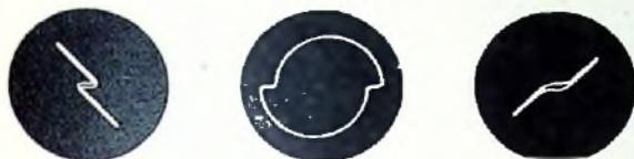
Abb. 3. Wird der Löschkopf als Sprechkopf benutzt, so ergibt sich ein gegenüber Abb. 2 etwas verzerrtes Schirmbild
