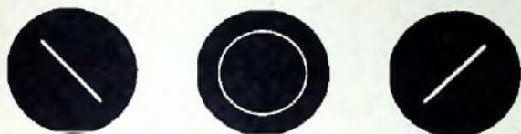
Abb. 2. Bei einer Schwankung der Phase um 180° pendelt das Schirmbild zwischen der nach links und der nach rechts geneigten Geraden über den Kreis periodisch hin und her. Die prozentuale Gleichlaufschwankung des Magnetongerätes läßt sich dann nach der Gleichung (2) berechnen
