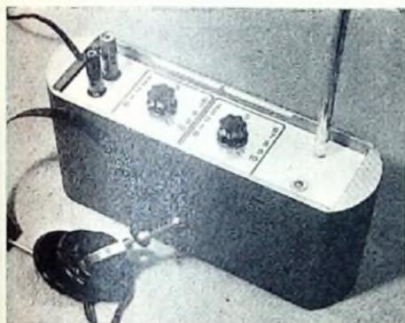
Außenansicht des Peilempfängers mit Kopfhörer und ausziehbarer Stabantenne
