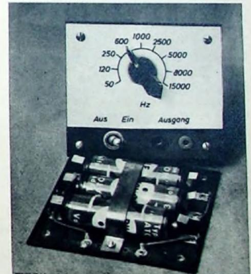
Abb. 7. Frontplatte des Gerätes, davor die Stabbatterien
