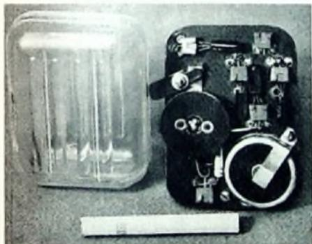
Abb. 3. Der Transistorverstärker neben seinem Gehäuse
