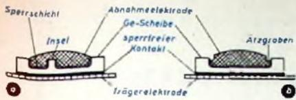
Abb. 6. Aufbau eines Germanium-Flächengleichrichters, a=ungeätzt (mit Insel), b=geätzt (mit Ätzgraben)
