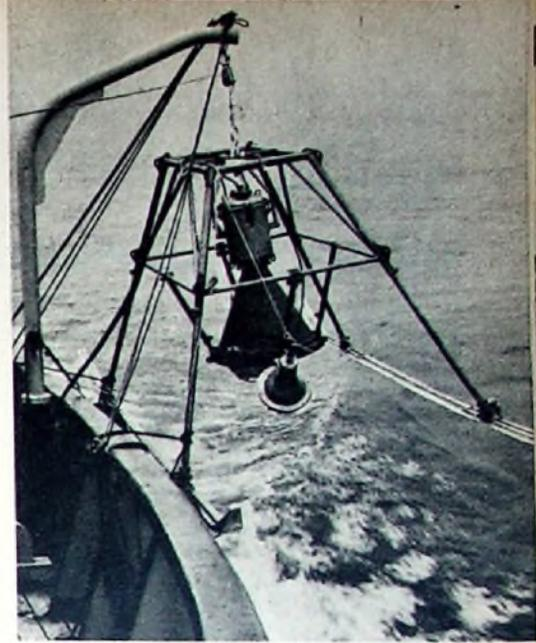
Abb 7. Unterwasser-Fernsehanlage „Ingatlas 4“ (Ingenieurbüro Atlas, Kiel), eingebaut im Grundgestell zum Schleppen über dem Meeresgrund mit Unterwasser-Scheinwerfer und Klarsichtvorsatz
