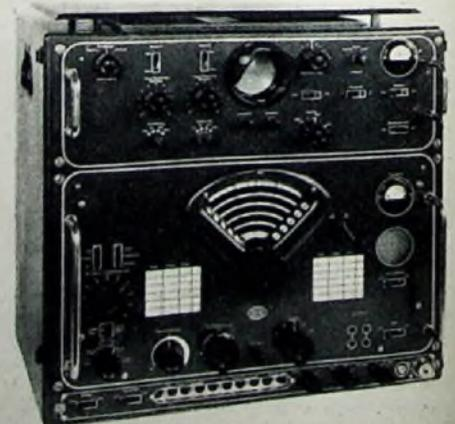
Bild 7. Funkfernseh-Empfängeranlage „4 P 304“ (1,5 ... 8,5 MHz bzw. 1,5 ... 30 MHz) von Lorenz, deren Fernschreiber-Zusatzgerät für die Auswertung von Twinplex-Sendungen eingerichtet ist
