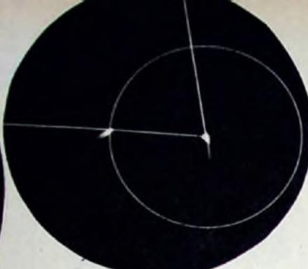
Bild 7 (links). Das Radarbild läßt deutlich den Unterschied zwischen Festzielen und bewegten Zielen erkennen. Bild 8 (oben). Elektronisch eingetastete Peillinie (nach links weisend) und einstellbarer Ring zum Messen der Zielentfernung
