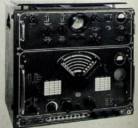
Bild 7. Funk-schreib-Empfängeranlage „6 P 304“ (1,5 ... 8,5 MHz bzw. 1,5 ... 30 MHz) von Lorenz, deren Fernschreiber-Zusatzgerät für die Auswertung von Twinplex-Sendungen eingerichtet ist
