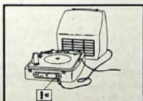
An diese Buchse können Sie außer dem Gehäuselautsprecher jeden niederohmigen Außenlautsprecher anschließen.
