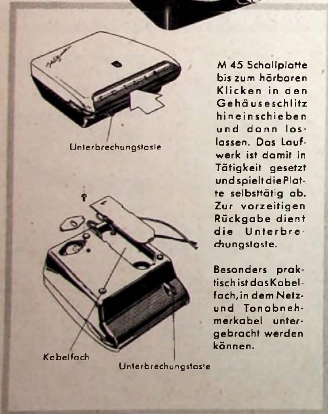
M 45 Schallplatte bis zum hörbaren Klicken in den Gehäuseschlitz hineinschieben und dann loslassen. Das Laufwerk ist damit in Tätigkeit gesetzt und spielt die Platte selbsttätig ab. Zur vorzeitigen Rückgabe dient die Unterbrechungstaste.
