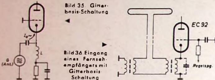
zwischen Gitter (Masse) und Katode liegt. Nun kann man den Anodenstrom als das Produkt aus der Steilheit  $S$  der Röhre mal der Gitterwechselspannung  $U_G$  auffassen. Ist der Belastungswiderstand  $R_b$  des Generators  $= U_G/I_a$  und ersetzt man  $I_a$  durch  $S \cdot U_G$ , dann ergibt sich  $R_b = 1/S$ . Bei einer Röhre EC 92 z. B. mit einer Steilheit von  $S = 0,005 \text{ A/V}$  ist der Belastungswiderstand, den die Röhre darstellt, gleich  $1/0,005 = 200 \text{ Ohm}$ .
