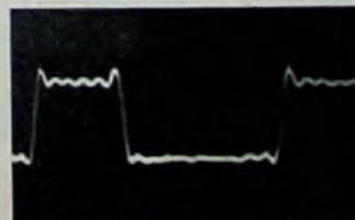
Bild 8. Klassisches Einschwingverhalten des Empfängers beim Betrieb am vorentzerrten Sender (am Video-Eingang)
