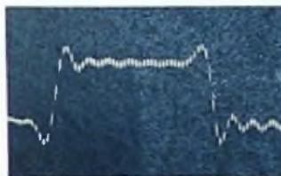
Bild 6. Rechtecksignal am Ausgang der Videostufe mit Kompensation der infolge Laufzeitdifferenz am oberen Frequenzbande entstandenen Fahne
