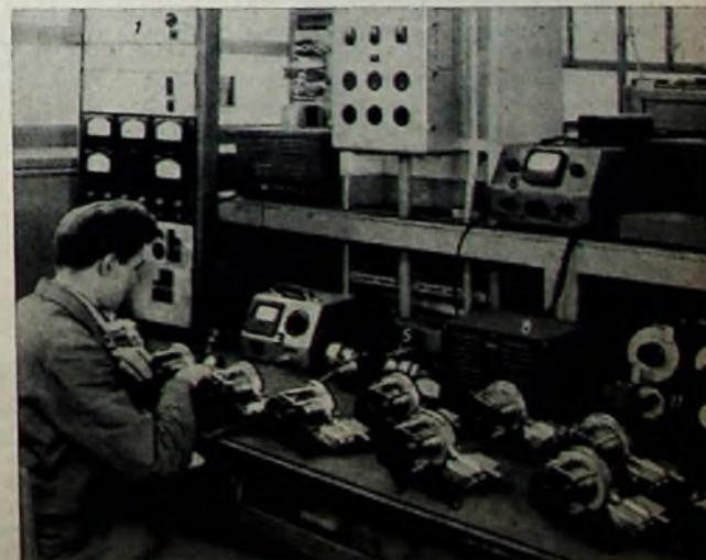
mehrmals kontrolliert werden. In gleicher Weise wird auch die Prüfung der Empfängerchassis (Bild 7), der Modulatorchassis usw. durchgeführt. Die Praxis hat gezeigt, daß einer solchen planvollen und systematisch durchgeführten, etappenweisen Prüfung eine hohe Sicherheit der IM-Anlagen gegen Ausfälle zu verdanken ist.
