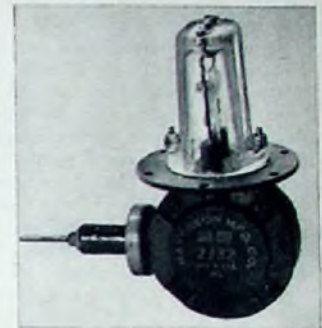
Bild 18. Magnetron 2J32 für 300 kW Pulsleistung der Firma Raytheon
