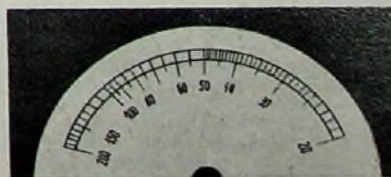
Bild 7. Ansicht der fertig gezeichneten Frequenzskala des Tongenerators
