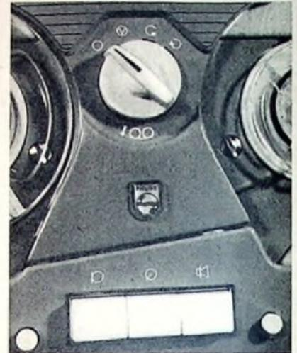
Hauptschalter (oben) und Drucktasten für „Aufnahme Mikrofon“, „Aufnahme Rundfunk“, „Wiedergabe“ mit Sperrtaste (links) und Stoptaste (rechts)
