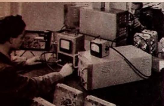
Bild 3. Prüfplatz für Rauschkontrolle des Verstärkers
